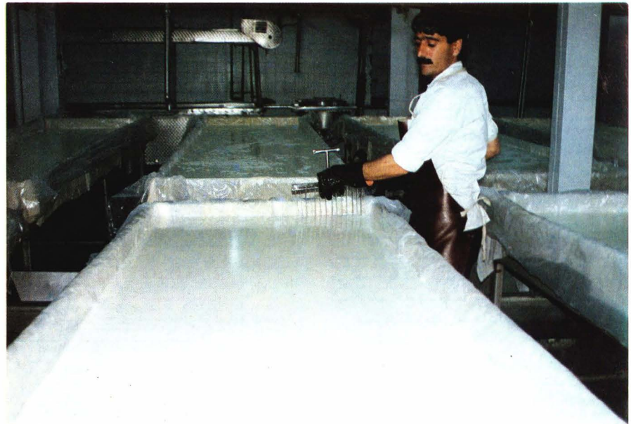
تصویر ۲- بریدن شیر منعقد شده بعد از مایه زنی (کارگاه پنیرسازی کارخانجات شیر پاستوریزه تهران)
