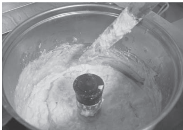
شکل ۶- ذوب شدن مخلوط مواد اولیه در اثر حرارت و عمل نمک امولسیون ساز (۱).
